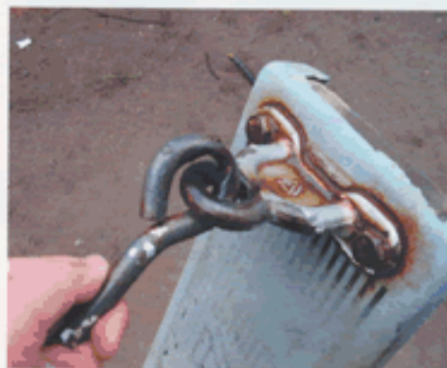
摩耗したぶらんこの鎖と台座の損傷
